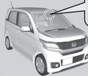
自車との速度差が 5km/h ~ 30km/h の車両に対して衝突のおそれがあるときに、システムの自動ブレーキが作動します。
