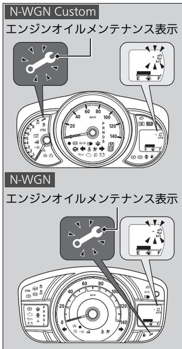
4. そのまま **SEL/RESET** またはセレクト / リセットノブを、エンジンオイルメンテナンス表示灯が点滅に切り換わるまでしばらく押し続ける。
