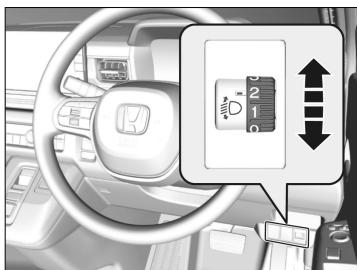
車幅灯が点灯しているとき、ヘッドライトの照らす方向（光軸）を下向きに調節することができます。光軸の調節はダイヤルを回して行います。ダイヤルの数字が大きいほど光軸は下向きになります。
