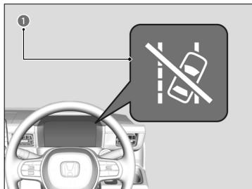
繰り返し路外逸脱抑制機能が作動しても、運転者の操作がない場合は警報音が鳴ります。その後、路外逸脱抑制機能操舵アシスト一時停止警告灯 (❶) が点灯し、操舵アシストが一時停止して警報音のみで警告します。
