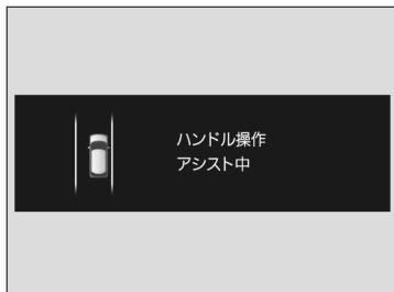
車線維持支援システム (LKAS) を作動させていない場合、車線逸脱、草、砂利などの道路境界や対向車両への接近の可能性を検知した場合にメッセージが表示される場合があります。
