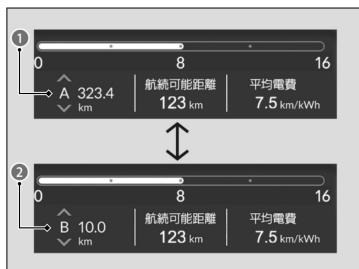
リセットしてからの走行距離を表示します。レフトセレクターホイールを回すと、トリップメーターの A、B が切り換わります。トリップメーター A と、トリップメーター B があり、それぞれ独立して計測するため 2 つの走行距離を知ることができます。
