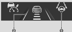
システムが作動中にハンドルから手を離したり、ハンドル操作量が少ない場合は警告を表示します。繰り返し表示されても操作がされない場合は警報音がなりシステムが解除されます。
