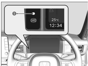
**POWER**を押したとき、キーの情報を認識できないとメーター内のイモビライザーシステム表示灯が点滅します。
