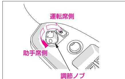
②調節ノブを動かして角度を調節します。
