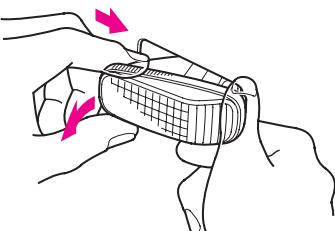
②ソケットを左へ回して外し、電球を抜き取ります。
