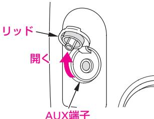
ポータブルオーディオなどのヘッドホン端子から、市販の接続コード(抵抗なし)を使ってAUX端子に接続します。
