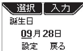
MODE/RESETスイッチを押し続けると“0→1→2…”の順に切り換わります。入力したい数字が表示されたらMODE/RESETスイッチから手を離します。
