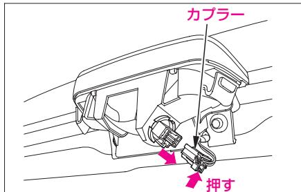
③ソケットを左に回して外し、電球を抜き取ります。
