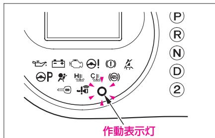
セットを解除するときは、キーレスエントリーまたはHondaスマートキーで解錠します。作動表示灯が消灯し、セットが解除されたことを知らせます。
