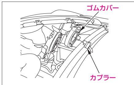
③止め金を外し、電球を外します。
