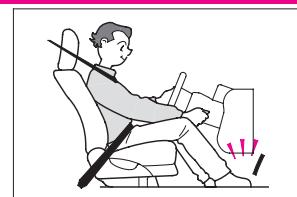
③アクセルペダルを踏まずに、エンジンスイッチを回します。
