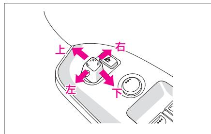
直接手で鏡面を動かして角度を調節することもできます。
