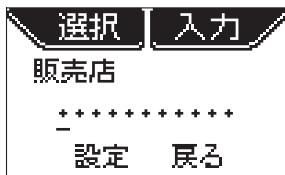
MODE/RESETスイッチを押し続けると“0→1→2…8→9→0…”の順に切り換わります。入力したい数字が表示されたらMODE/RESETスイッチから手を離します。
