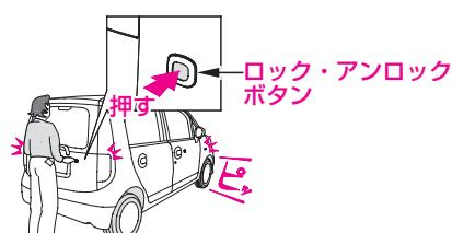
解錠時はアンサーバックブザーが“ピピッ”と鳴り、非常点滅表示灯が2回点滅します。
