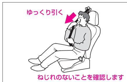
③ベルトにねじれがないようにし、タングプレートをバックルの中へ“カチリ”と音がするまで差し込みます。
