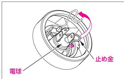
止め金の状態はヘッドライト部の確認窓より確認できます。
