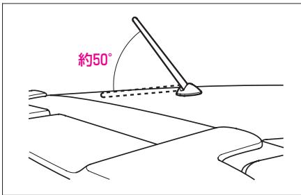
自動洗車機を使った場合など、アンテナが倒れてしまった場合は、元の位置（後方約50°）に戻してください。
