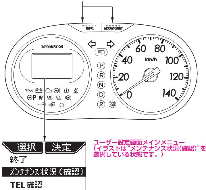
通常表示に戻るときは、インフォメーション(INFO.)スイッチを押して“終了”を選び、MODE/RESETスイッチを押して“決定”します
