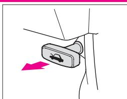
②ボンネットのレバーを押し上げながら開け、ステーで固定します。
