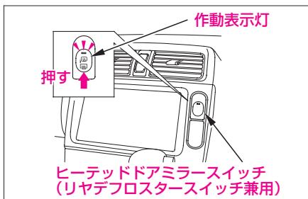
エンジンスイッチが“II”的とき、スイッチを押すと“ON”になり、同時に作動表示灯が点灯します。もう一度スイッチを押すと“OFF”になり、作動表示灯は消灯します。
