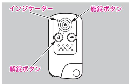
キーレスエントリーで施錠・解錠を行うと、非常点滅表示灯が施錠時は1回、解錠時は2回点滅します。
