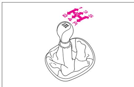
変速するときは、クラッチペダルをいっぱい踏み込んで、チェンジレバーを確実に操作します。
