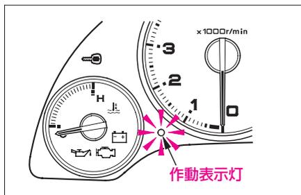
セットを解除するときは、キーあるいはキーレスエントリー用発信器で解錠します。作動表示灯が消灯し、セットが解除されたことを知らせます。
