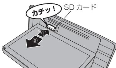
SDカードが飛び出し、抜き取れる状態になります。ゆっくりと抜いてください。
