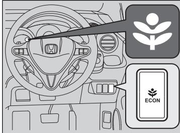
スイッチを押すとエンジン、CVT、エアコン、IMA システムの作動を制御して、省燃費運転をしやすくするように制御します。
