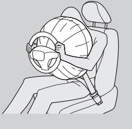
前方向から衝突すると、シートベルトが乗員の下半身と胴体を拘束し、SRSエアバッグが頭と胸部を保護します。
