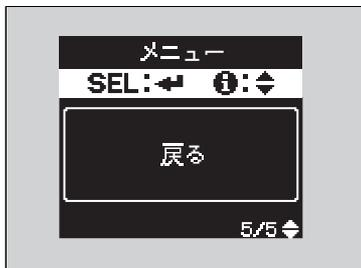
4. インフォメーション( ⓘ )スイッチ( ▲ / ▼ )を押し、「トリップ A の給油連動リセット」が表示されたら、**SEL/RESET** を操作する。
