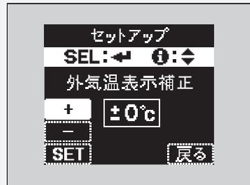
表示されている補正温度(工場出荷時は±0°C)より高めに設定したい場合は、インフォメーション(**i**)スイッチ(▲/▼)で「+」を選択し、**SEL/RESET** スイッチを押しして1°Cずつ補正温度を上げます。希望の温度になったらインフォメーション(**i**)スイッチ(▲/▼)で「SET」を選択し、**SEL/RESET** スイッチを押しして設定を完了します。
