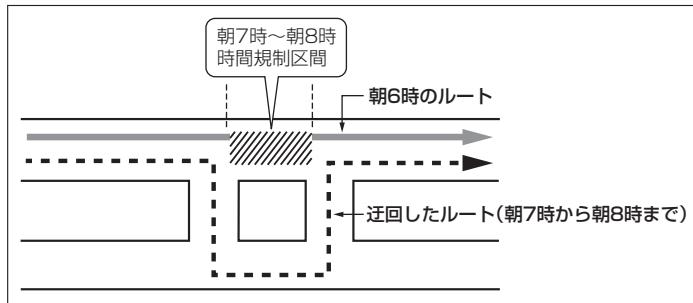
ルート探索した時間が朝6時のときは迂回しないルート探索をしますが、実際に運転されていて朝7時を過ぎると自動的に再探索され、迂回するルートに変わります。
