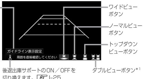
後退出庫サポートのON／OFFを切り替えます。 [図] I-25
