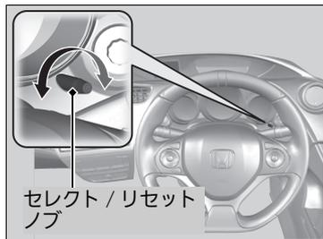
パワーモードがONモードのとき、セレクト/リセットノブでインストルメントパネルの明るさを調節することができます。
