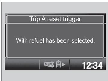
4.  $\boxed{+}$ / $\boxed{-}$ スイッチを押して「Trip A reset trigger」を選択し SOURCE スイッチを押す。
