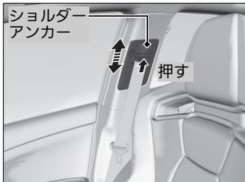
フロントシートのシートベルトは、座高に合わせて、ショルダアンカーの高さを調節してください。
