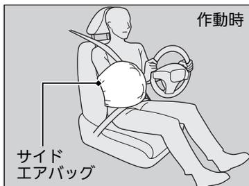
サイドエアバッグは、約 30km/h 以上の速度で自車と同等の車が真横から衝突したときと同等か、それ以上の衝撃を受けたときに運転席または助手席のサイドエアバッグが膨らみます。
