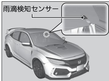
レバーを **AUTO** の位置にするとワイパーが 1 回作動し、その後は自動作動に切り換わります。フロントガラス上部にある雨滴検知センサーが検出した雨滴量に応じて、停止、間欠作動、低速作動、高速作動のいずれかの作動をします。
