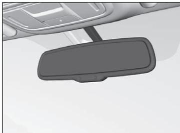
夜間走行時、後続車のヘッドライトの反射を自動的に弱くできます。
