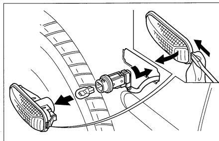
**制動灯／尾灯、後面方向指示器／後面非常点滅表示灯、尾灯、後退灯**
