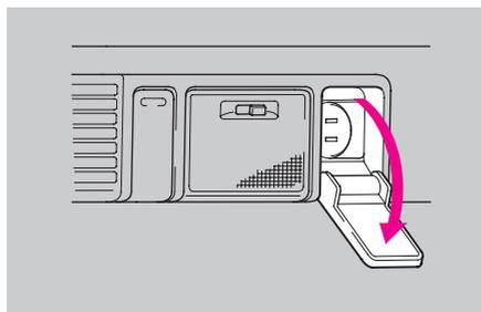
②プラグの先端を少し入れてから、時計回りに90°回して差し込みます。
