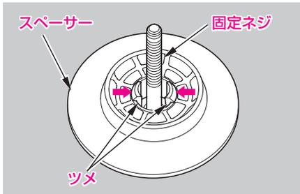
③ パンクした標準タイヤをしまい、スペーサーを、応急用スペアタイヤを固定していたときとは逆向きにして固定します。
