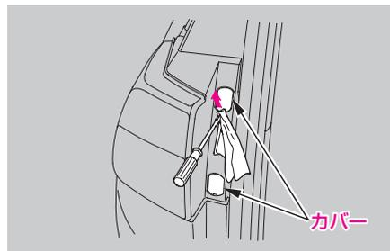
②ネジを外し、クリップを引き抜き、ランプ本体を外側に引いて外します。
