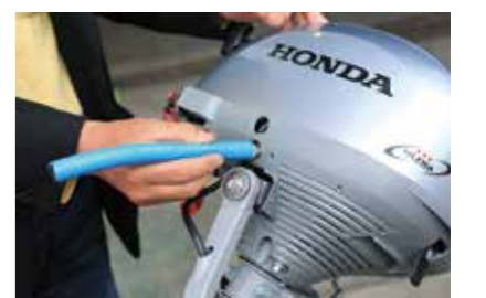
③水洗用アダプターに、適当な長さのホースを取り付ける
