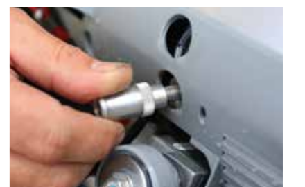
②水洗用アダプターを取り付ける。ネジ径が同じなのでピッタリはまる
