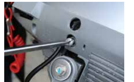
①オイルドレンプラグを上を向く状態に船外機を傾けて、プラグを外す
