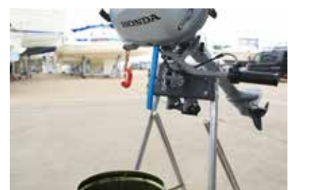
④船外機を反対側に傾け、古いオイルを排出。船外機をオイルで汚すことはない
