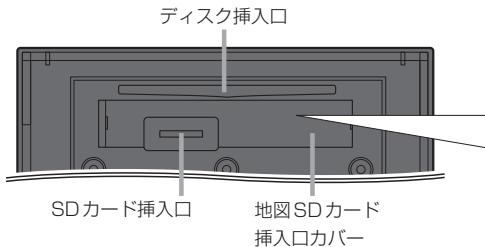
**地図SDカード挿入口カバーの取り付け／取り外し**
