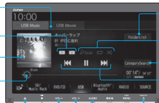
音量を調整します。 AUDIOメニューを表示します。 AUDIOメニューでは、オーディオソースの選択が行えます。
