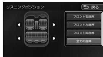
選択したリスニングポジションに合った DTA (Digital Time Alignment) が設定されます。
