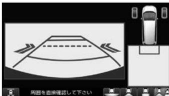
リアカメラの映像が表示され、ガイドラインが表示されます。
