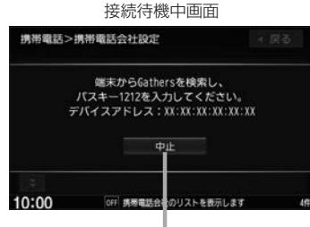
※接続待機中に [中止] をタッチすると接続待機を中止し、携帯電話会社設定画面に戻ります。
