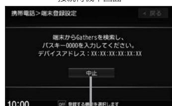
※接続待機中に [中止] をタッチすると接続を中止し、端末登録設定画面に戻ります。
