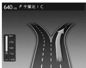
以下の分岐点の手前では、道路形状をデフォルメ化した拡大図が表示されます。
