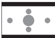
画面の横幅と映像の幅を合わせて表示する。映像と画面の比率が違う場合は、上下に黒い帯が表示されます。
