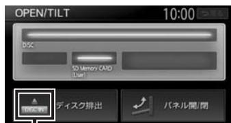
ディスクがセットされている場合、「DISC IN」部分が明るく表示されます。
