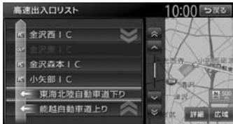
「分岐・合流」を表す道路名をタッチした場合は、高速出入口リストが表示されます。同様に、変更する出入口を選択してください。
