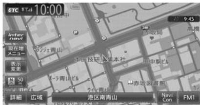
画面下に表示されるスケールコントロールバーの尺度をタッチしても、同様に地図が拡大／縮小されます。50m、100m、200m、500m、1km、2kmからスケールを選択できます。3秒間操作がない場合、スケールコントロールバーは非表示になります。
