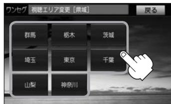
選んだ地域(エリア)のチャンネルリストを作成し、地域(県域)で放送されている放送局がすべて **1** ~ **12** (エリア)にプリセット(メモリー)されます。
