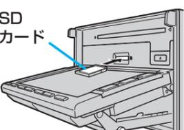
**2 SDカード挿入口にSDカードをカチッと音がするまで差し込む。**
