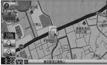
アンテナ3本：電波状態良好
