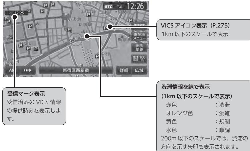
地図をスクロールしてカーソルを VICS 情報のランドマークに合わせると、VICS アイコン情報が表示されます。VICS アイコン情報は、「地図上に表示する情報を設定する」(P.107)で表示／非表示を設定できます。
