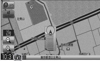
アンテナ3本：電波状態良好
