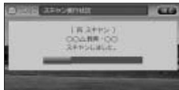
：全チャンネル(13ch~62ch)をスキャンし、放送局を **1** ~ **12** ボタン(エリア)に追加プリセット(メモリー)します。
