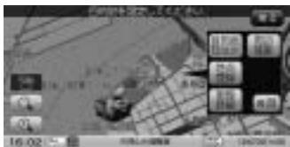
施設を中心とした地図が表示されますので、位置を確認して**目的地セット** ボタンをタッチします。
