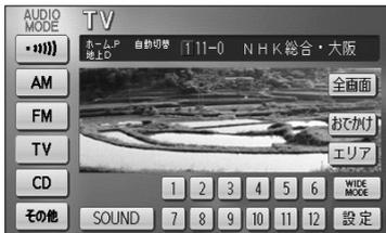
(1) デジタルテレビ操作画面 (P.7-16参照) でプリセットスイッチにタッチして選局します。
