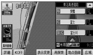
(1) 自車が高速道路の本線上にあるとき、**案内図替** にタッチします。
