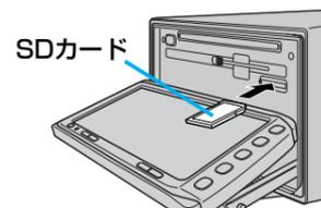
2 SDカード挿入口にSDカードをカチッと音がするまで差し込む。
