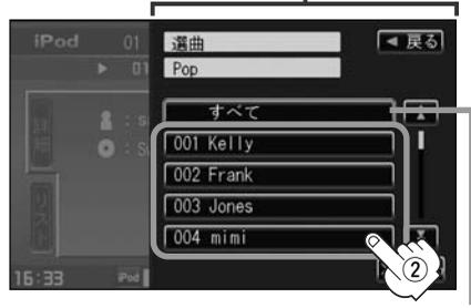
**すべて** ボタンをタッチすると①で選択したジャンルに該当するアルバムが表示されます。-さらに**すべて** ボタンをタッチするとiPod内のトラック表示とともに曲が再生されます。
