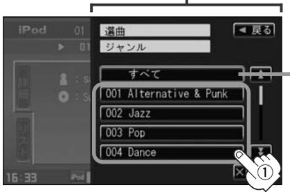
**すべて** ボタンをタッチするとiPod内のアーティストが表示されます。-さらに**すべて** ボタンをタッチするとiPod内のアルバムが表示されます。-さらに**すべて** ボタンをタッチするとiPod内のトラック表示とともに曲が再生されます。
