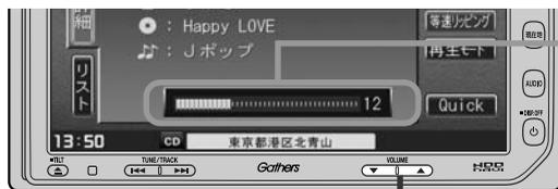
音量を調整すると画面に現在の音の大きさ(0～40)を示すVOLUME<sup>ボリューム</sup>が表示されます。
