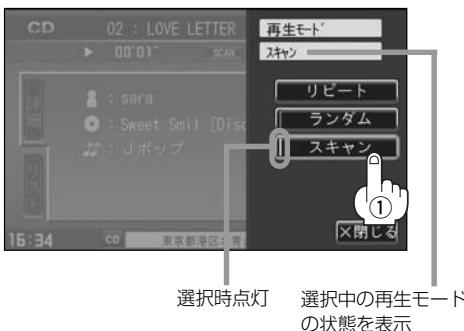
：表示灯点灯し、曲の頭(イントロ)を約10秒再生し、次の曲へ移る動作を繰り返します。
