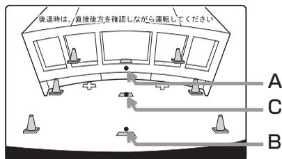
画面上では、自車から約1m先のCの位置にトラックが駐車してあるように見えますが、実際にはBの位置まで後退するとトラックに接触してしまいます。
