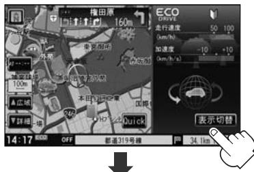
(例) 走行速度・加速度履歴グラフを表示
