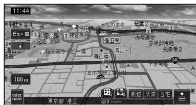
詳細市街地図収録エリアでは、10m～50mスケールのときに立体的な市街地図が表示されます(スカイシティマップ)。
