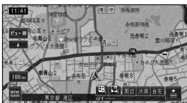
詳細市街地図収録エリアでは、10m～50mスケールのときに詳細な市街地図が表示されます(シティマップ)。
