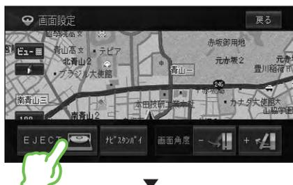
モニターが開き、ディスクが自動的に押し出されます。
