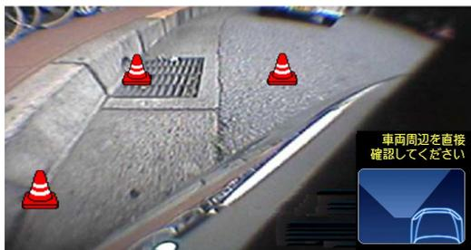
コーナーカメラシステムで、車の左前方向の視野範囲をモニターで確認することができます。苦手な縦列駐車をサポートします。
