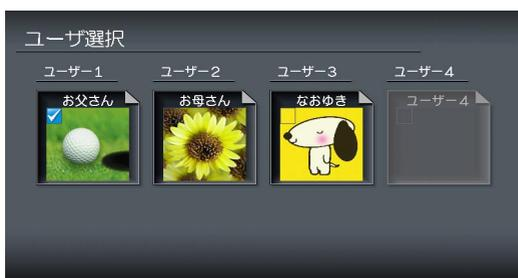
本機の各種機能の設定やお知らせ情報などを、本機を使用するユーザーごとに設定しておくことで、エンジンをかけた後に表示されるユーザー選択画面からワンタッチ操作で使用するユーザーの設定内容に切り替えることができます。
