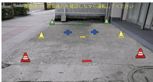
リバースギヤと連動し、画面に車両の後方を写し出します。車幅や後方の距離感の目安となるガイドライン表示機能も搭載。運転席からの視野を大きく広げ、後方が見えにくいときのセーフティドライブをサポートします。
