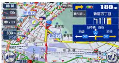
「オートスケール」誘導の場合に、進行方向上向きで地図を表示していると、約300m手前で曲がる方向を広く表示するように地図が左右に移動します（サイドワイド機能）。ただし、方面看板が表示されているときの左折案内では、地図は移動しません。
