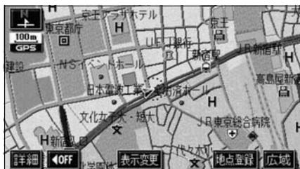
3個以上のGPS衛星からの電波を受信して、自転車の現在地を測定することです。本機では、現在地画面の左上隅に表示する「GPS」マークの色により衛星の状況を表示しています。
