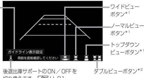
\* ガイドライン表示設定は、カメラ映像をタッチすると表示されます。
