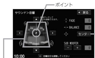
イラストを直接タッチし、ポイントを移動させて調整することもできます。
