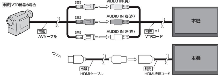
※車両によってはHDMI接続コードの代わりにHDMI接続ジャックを使って接続する場合があります。
