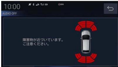
検知方向は左前方、真ん中左前方、真ん中右前方、右前方、左後方、真ん中左後方、真ん中右後方、右後方の8方向です。
