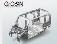
衝突時の衝撃(G)を制御するHonda独自の安全技術「G-CON」。軽量かつ高強度な素材を各所に配置することで衝突安全性能に貢献しています。
