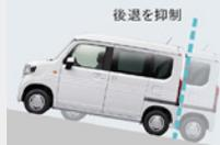
坂道発進時、ペダルを踏み替える瞬間のクルマの後退を約1秒間抑制。坂道での渋滞時などで効果を発揮します。
