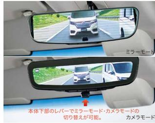
車両後方のカメラ映像を表示するカメラモードと通常のミラーモードの切り替えができます。後席の同乗者や荷物で視界が狭くなる時や、雨天時、夜間、夕暮れ時でもクリアで広い後方視界を確保し、走行時の安全運転をサポートします。
