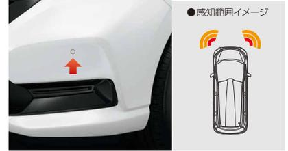
車両のフロントコーナーに設置する、2つのセンサーが障害物を感知。
