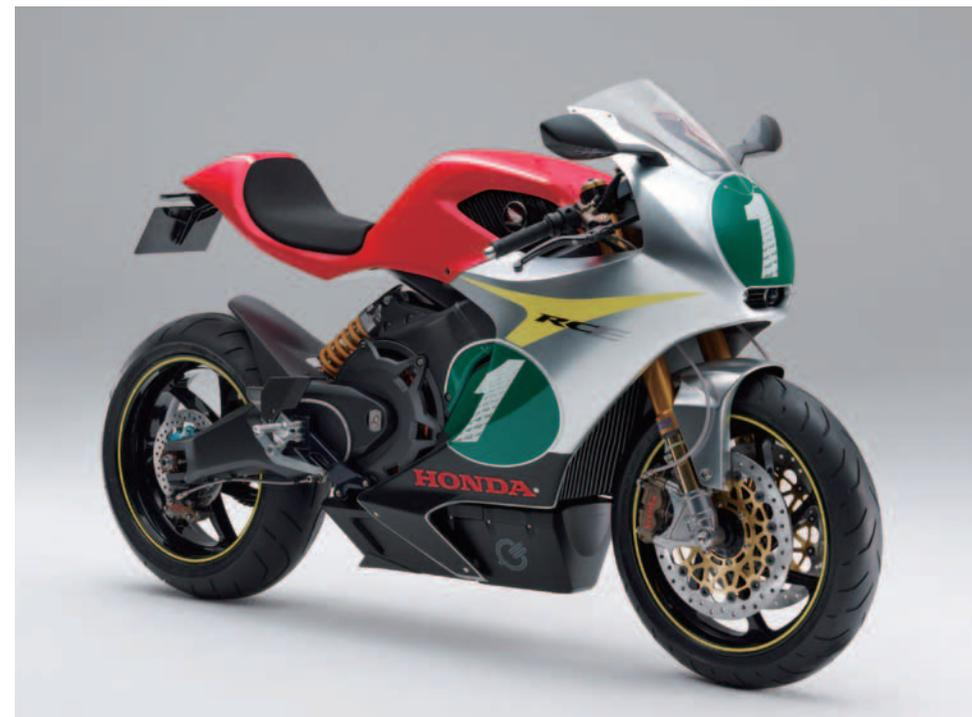
スーパースポーツをEV化し、走りの喜びを追求したスポーツモデル。スタイリング、カラーリングは、Hondaスポーツバイクの原点である往年のレーシングマシン「RC」のイメージをモチーフに、シンプルかつモダンなボディーデザインにエモーショナルなグラフィックを採用しています。バッテリーは従来の燃料タンク位置と車体下部に配置。さらにモーターをスイングアームピボットと同軸とすることでマスの集中化を徹底しました。250ccクラスのコンパクトな車体サイズとEVならではのトルクフルでスムーズな走りによる、スーパースポーツの将来に向けた提案モデルです。
