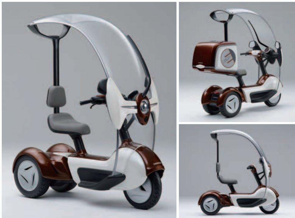
Honda独自のスリーター(三輪スクーター)にEVシステムを搭載した静かで快適な次世代コミューター。市街地でのパーソナルユースだけでなく、ビルトイン可能なリアトランクの採用により、デリバリーなどのビジネスユースにも活用できます。コンパクトな車体に、防風・防雨・防塵効果を発揮しながら視界を妨げないクリアなキャノピーを装備。安心感のある低重心フォルムで、軽快かつフレンドリーなスタイリングを追求しています。
