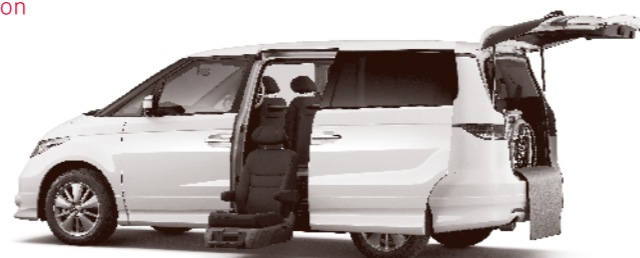
サイドリフトアップシート車 エリシオン Elysion side lift-up seat vehicle
