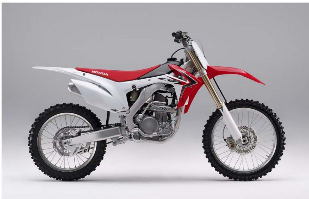
パワーユニットは、従来から高い評価をいただいている高速域の出力を維持しつつ、低中速でのトルクを向上させました。従来製品に対して、圧縮比アップ(13.5)/燃焼室形状/吸・排気ポート形状/インジェクター噴霧角度等に変更を加え、吸排気やトランスミッションなどの各部を新設計しました。
