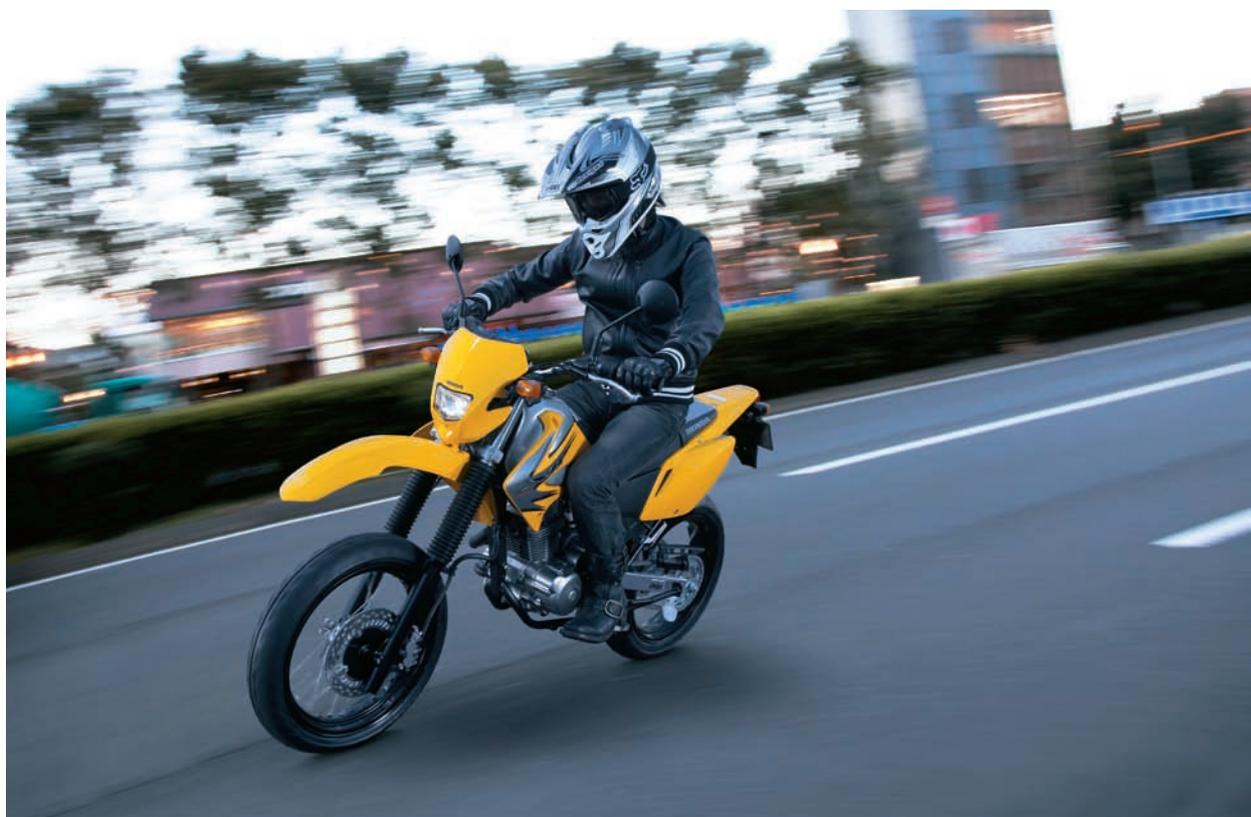
XR230 モタードの前・後輪は、17インチで幅広のアルミ製ホイールにオンロードタイヤを組み合わせ装着しています。フロントには、3.00-17サイズのアルミホイールに、110/70-17サイズのタイヤを装着。リアには、3.50-17サイズのアルミホイールに、130/70-17サイズのタイヤを装着し、オンロードで路面追従性に優れた快適な走りを実現しています。また、リアクションユニットの全長を、XR230に比較して3mm延長するとともに、XR230 モタード専用のセッティングを施しています。
