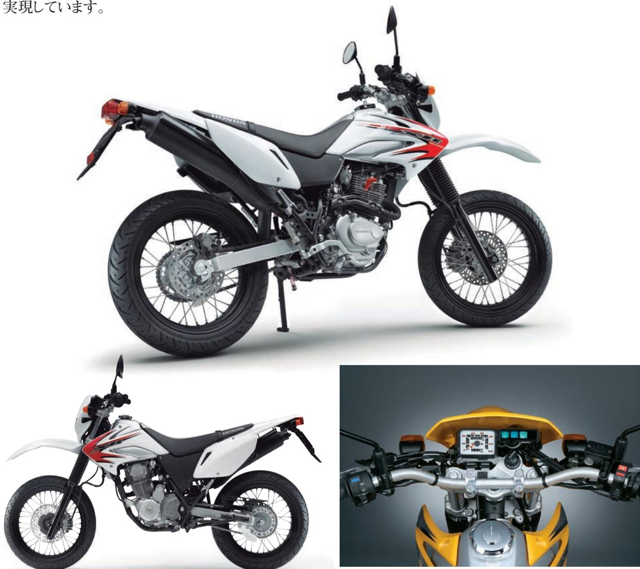
軽量でコンパクトな空冷・4ストローク・OHC・223cc単気筒エンジンは、環境性能と市街地やツーリング走行で力強い走りを両立させるために、XR230と同様にキャブレターのセッティングを変更し、より適正な混合気の供給を可能としています。また、排気ガスを浄化する触媒装置(キャタライザー)を、エキゾーストパイプとマフラーにそれぞれ内蔵し、従来からの二次空気導入装置(エキゾースト・エアインジェクションシステム)も併せて採用することで、平成18年国内二輪車排出ガス規制に適合させています。
