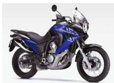
‘08 XL700Vトランザルプ（欧州） アグレッシブな外観に前輪の21インチから19インチへの変更でより軽快なハンドリングを実現。排気量アップと併せてさらにスポーティーな運動性能を発揮。
