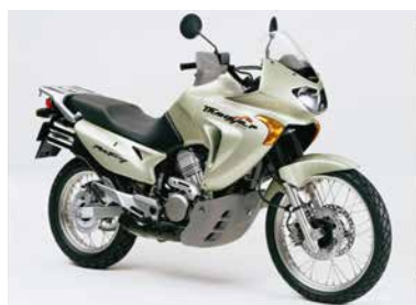
‘00 XL650Vトランザルプ（欧州） マス集中を図った車体と600ccからの排気量アップで運動性能と動力性能を向上。併せて電装関連の進化を図り、さらに豊富なアクセサリーによりライダー個々の用途に合わせた仕様を可能とした。
