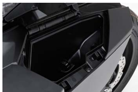
右側 フロントユーティリティーボックス
