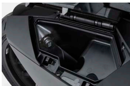
左側 フロントユーティリティーボックス
