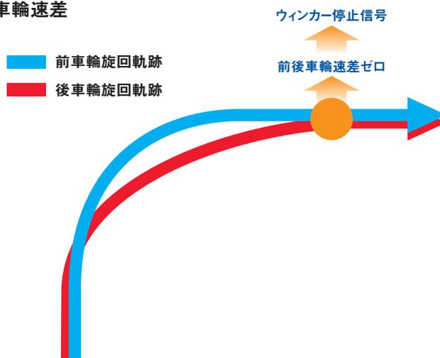
旋回時の前車輪と後車輪の軌跡違いにより発生する車輪速の差を利用し、旋回中であると判断し、車輪速の差がなくなった時点で旋回は終了と判断。その時点でウィンカーを停止させます。
